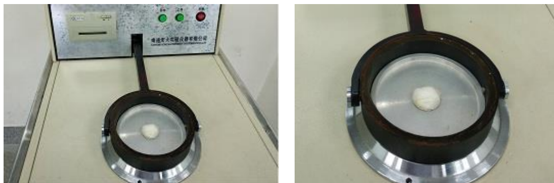
图 5-1 蓖麻蚕茧透气性能测试
