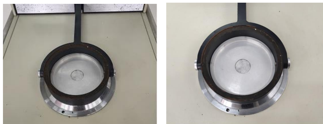
图 5-2 蓖麻蚕平板丝透气性能测试
